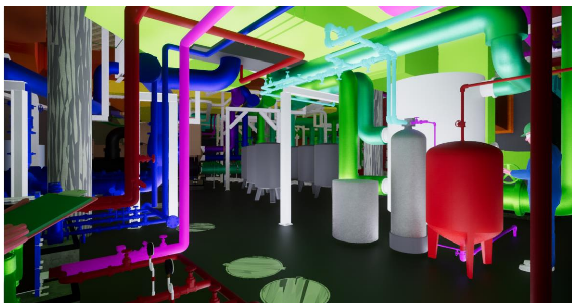
Hình 19 Minh họa mô hình phòng máy trong giai đoạn thiết kế bản vẽ thi công 3
