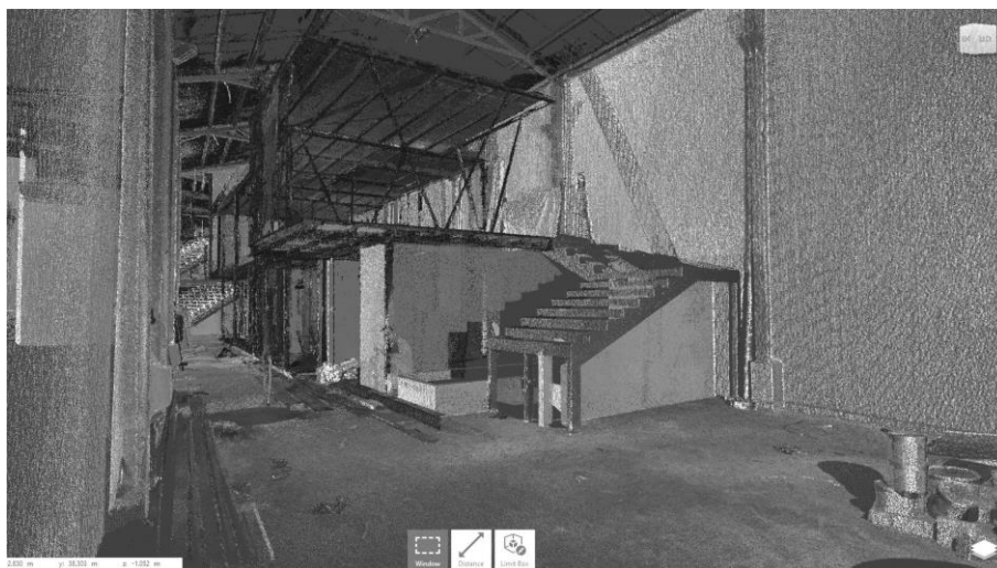
Hình 1.3 Minh họa mô hình đám mây điểm hiện trạng công trình 5
